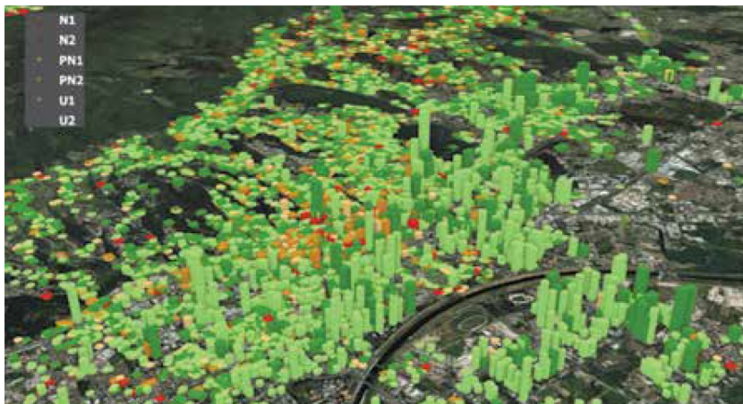
Slika 8 Prikaz oštećenja stambenih i stambeno-poslovnih zgrada prema oznakama uporabljivosti (boje) i bruto razvijenoj površini (visina stupca) na perspektivnom prikazu karte (Novak et al., 2020)
